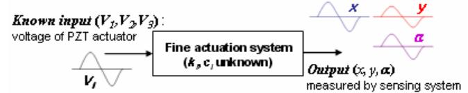
Fig. 5 Experimental process of parameter estimation
