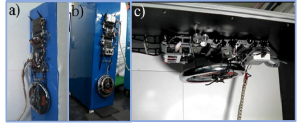
그림 4. 로봇의 유효하중 능력: (a) 수직 벽 상승 시 10kg, (b) 수직 벽 하강 시 15kg 유효하중 능력 및 (c) 천장 부착 시 10kg 유효하중 능력
