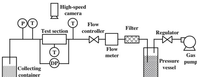
Fig. 1. Experimental apparatus.
